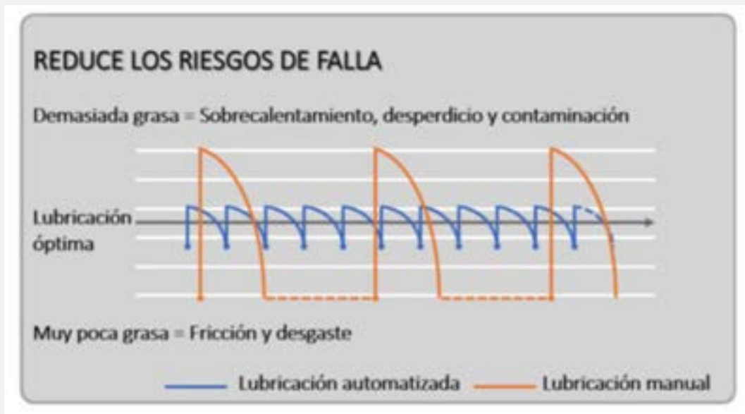
Riesgos de falla asociados con la lubricación manual
