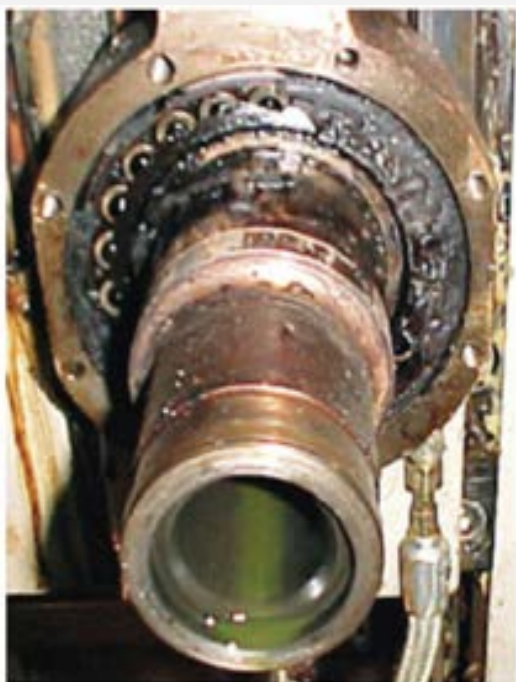
Figura 1. Esta grasa muestra señales de endurecimiento extremo resultado de la presencia de cobre oxidando prematuramente el aceite base en la grasa. La alta concentración de metal catalítico de cobre en la grasa proviene de partículas de desgaste.
