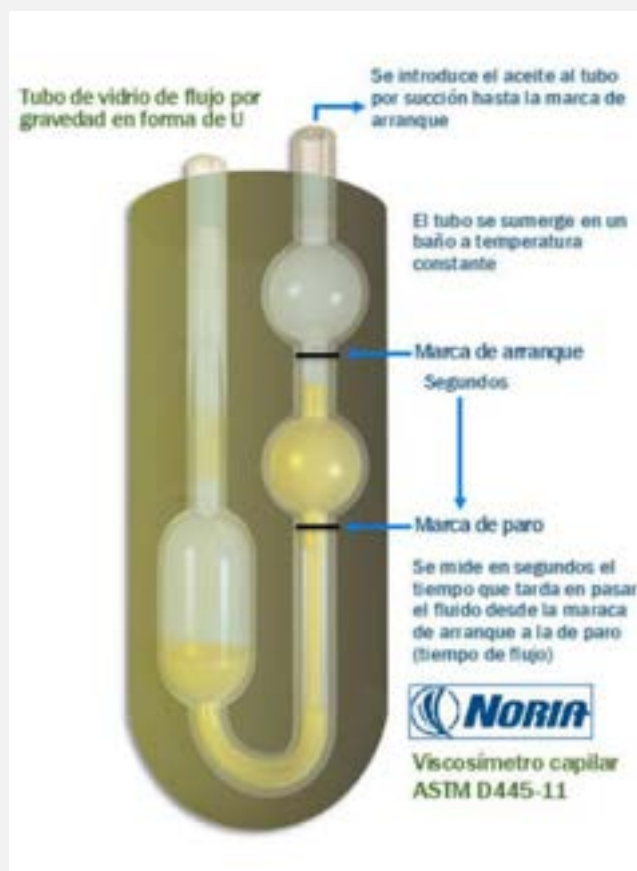
Figura 1. Viscosímetro capilar en U
