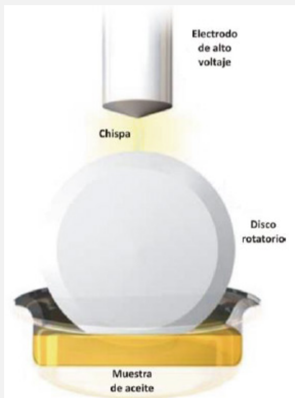
Figura 1 – Espectrómetro por electrodo y disco rotatorio (RDE)
