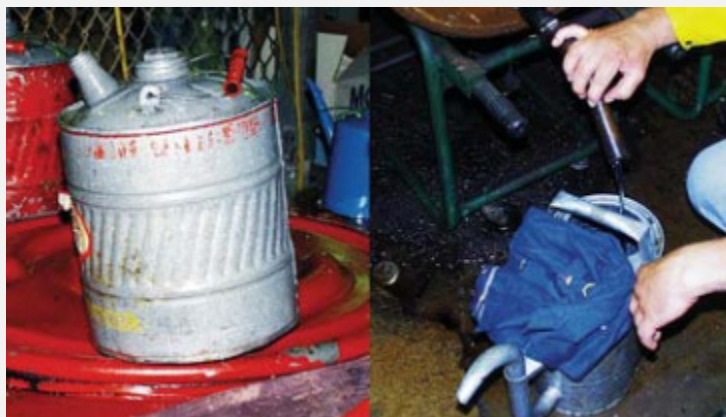
Figura 2. Contenedores de relleno inadecuados
