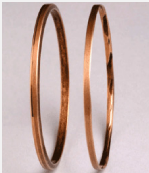
Figura 3. Un anillo de aceite en estado nuevo (ancho y achaflanado) a la izquierda, y uno en estado desgastado (angosto y sin chaflán) a la derecha
