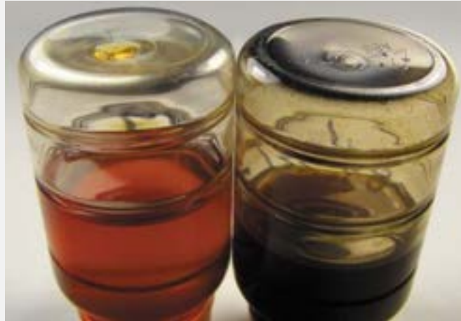
Figura 2 - El resultado de la prueba MPC de la muestra de la izquierda fue de 24, mientras que el de la derecha fue de 156 (Foto cortesía de Dave Wooton, Wooton Consulting)
