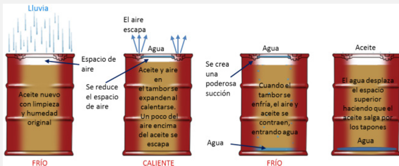
Figura 3. Cómo ingresa el agua a sus tambores por el almacenamiento a la intemperie
