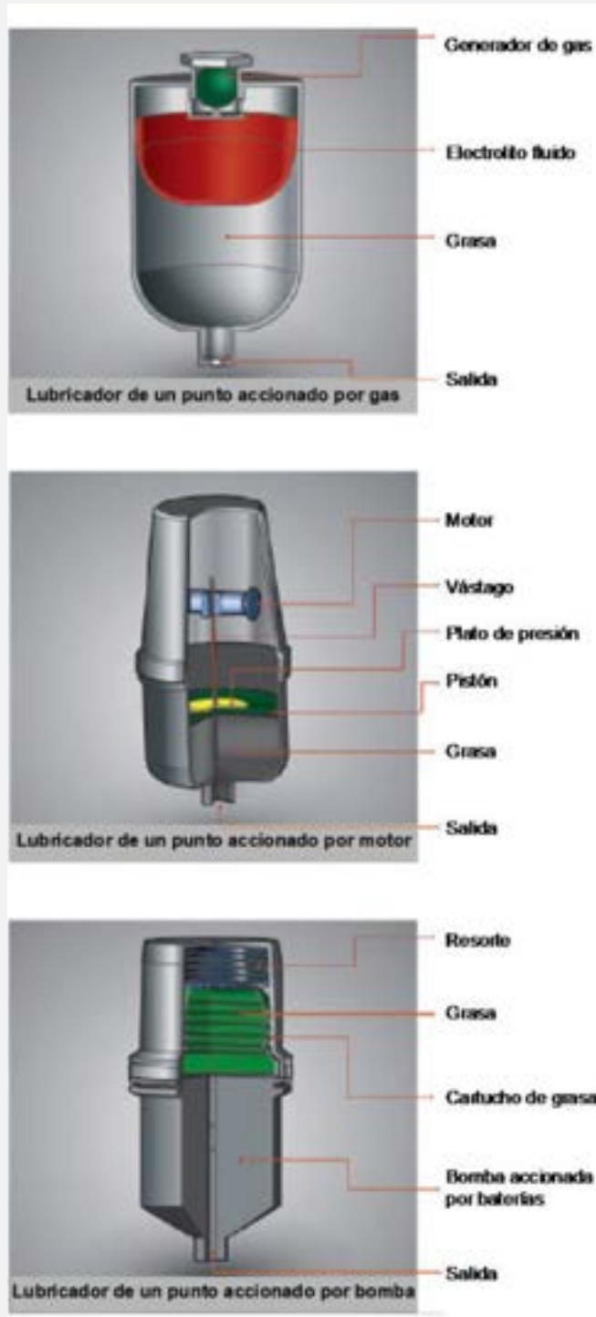
Fig. 5 - Modelos básicos de lubricadores de un solo punto
