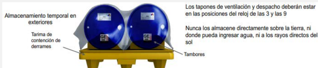
Figura 2. Almacenamiento temporal de lubricantes a la intemperie
