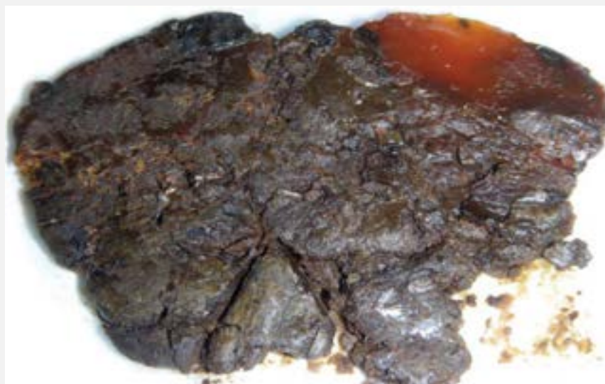
Figura 1. Esta grasa muestra señales de endurecimiento extremo resultado de la presencia de cobre oxidando prematuramente el aceite base en la grasa. La alta concentración de metal catalítico de cobre en la grasa proviene de partículas de desgaste.
