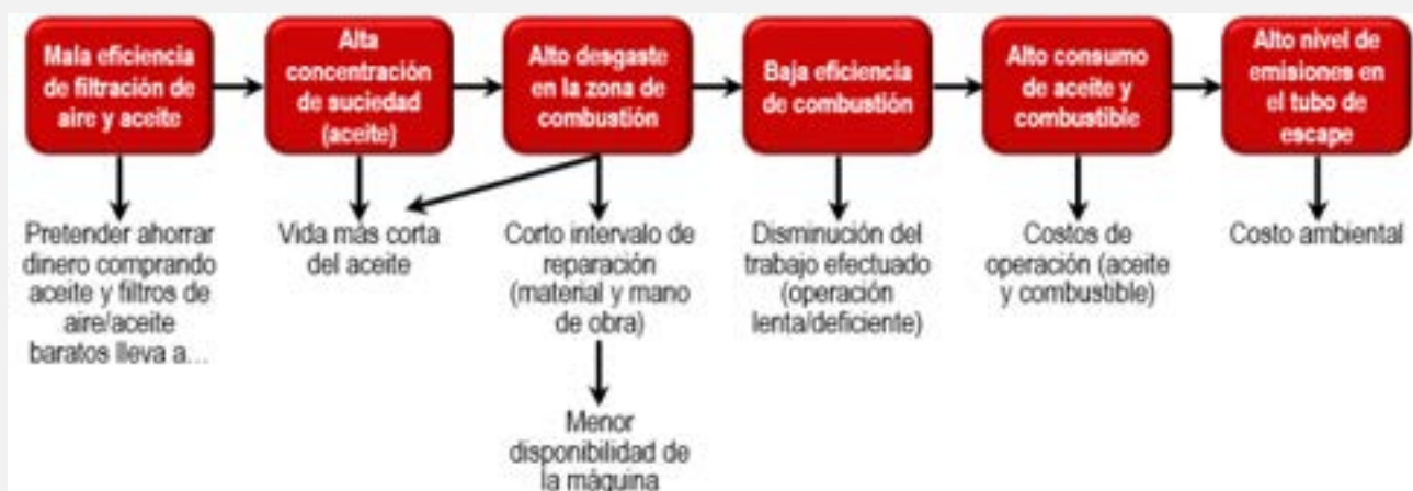
Figura 1. Daños al motor por una deficiente filtración
