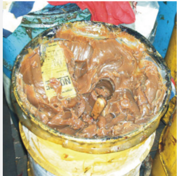
Figura 1. Efectos de un almacenamiento deficiente de grasa
