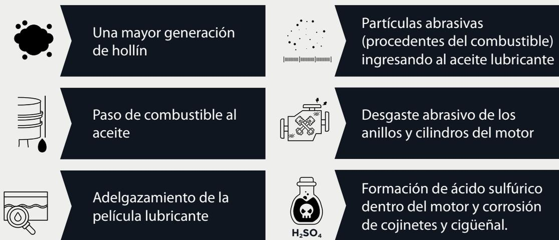
Esto lleva a la **disminución de la vida del motor**. Lo podemos apreciar en esos motores que emiten humo negro y azul como evidencia de una combustión inadecuada y el paso del lubricante a la zona de combustión donde el aceite se quema. Tenemos ahora un ciclo destructivo que se caracteriza por mayor consumo de combustible, menor potencia, mayor contaminación y disminución de la vida del motor.
