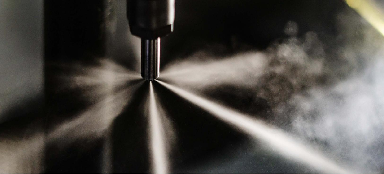
Cuando hay partículas en diésel, éste no será pulverizado correctamente. Se aplica una cantidad mayor de la requerida en la cámara de combustión y en gotas mayores en tamaño, que no se quemarán completamente. Como consecuencia tendremos:
